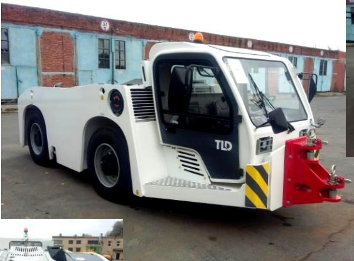
Тягач водильный для буксировки воздушных судов TMX-350-24 TLD
